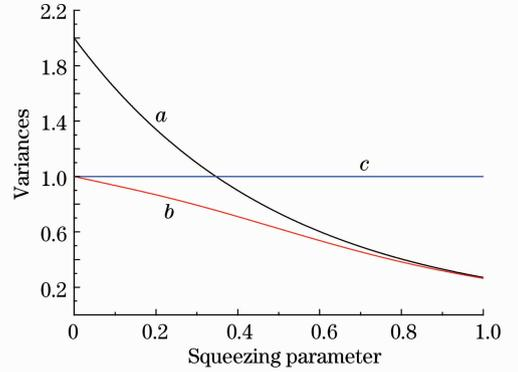
图 4 六组份星型 Cluster 纠缠态不可分判据左边关联方差与压缩参量之间的关系
